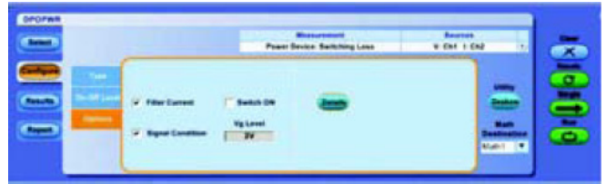
圖 13. TDSPWR3 軟體功能表上的訊號調整選項。此選項會在切換裝置「關閉」期間，將電流設為零。
