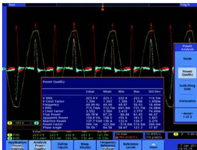
圖 2. 電源品質參數量測
