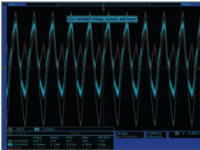
圖 20. 使用 MSO4000 系列示波器進行 CCFL 背光功率測試的顯示介面
