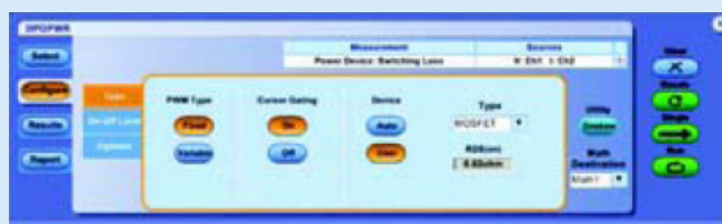
圖 7. DPOWWR 輸入頁，可讓使用者輸入 R_{DS_{on}} 和 V_{CE_{sat}} 的資料表單值
