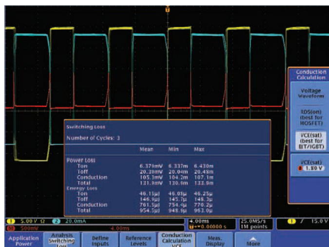
圖 13. 對 IGBT 進行的 DPOxPWR 切換損耗量測
