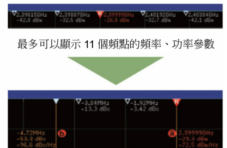
如果使用手動標記顯示功能，還可以顯示量測雜訊密度和相位雜訊參數
