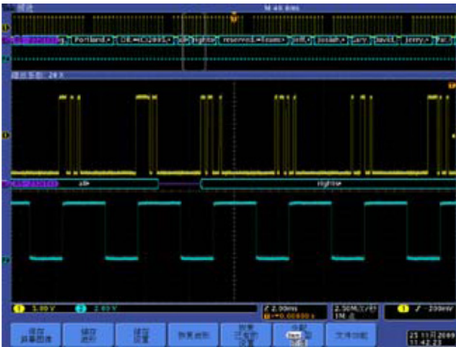
圖 4. 黃色的 RS232 波形自動解碼，同時測試到一組時脈訊號
