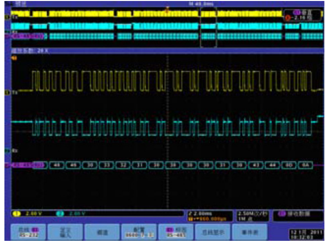
圖 7. RS485 匯流排的觸發和解碼
