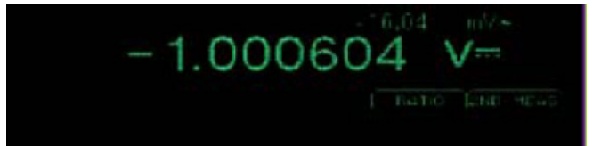
圖 4. 使用 DMM4000 數位萬用電錶的雙參數量測功能測試漣波
