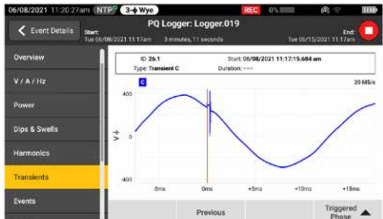
在記錄的同時檢視即時電壓暫態事件，以加速故障排除
