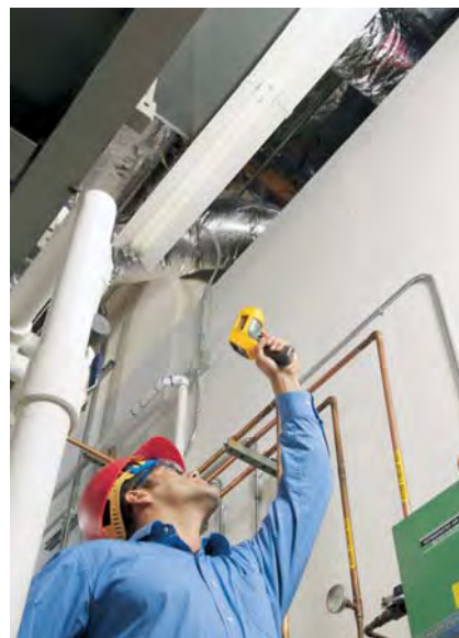
测量这个光亮的铝制管道时调节发射率十分重要，否则温度会看上去会过低。
